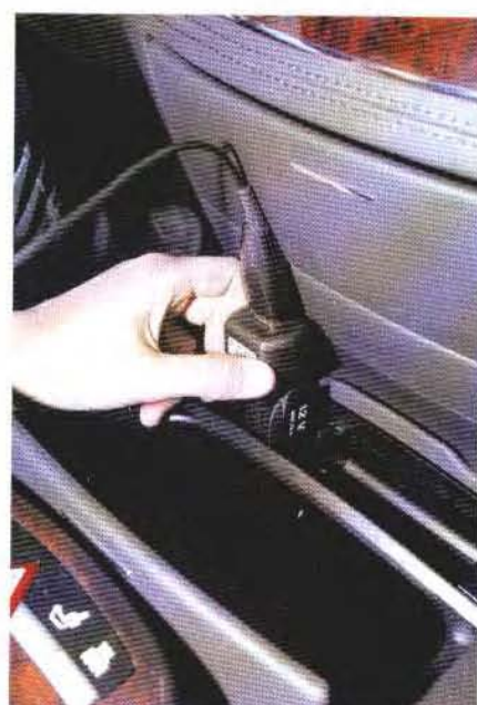
La base de datos del 'Inforad' se conecta a la toma de mechero del vehículo.
